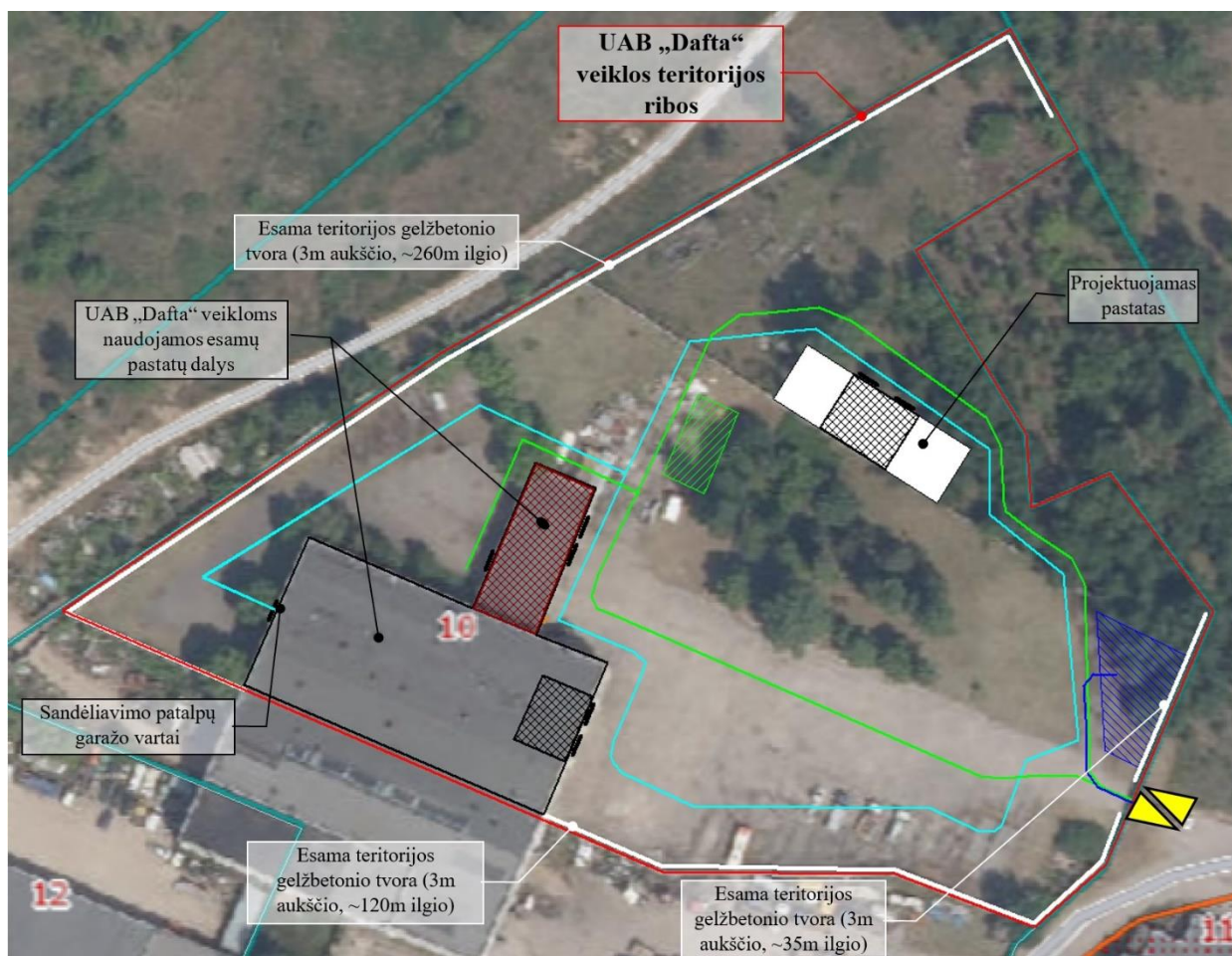
14 pav. PŪV teritorijos ribos, įvažiavimo padėtis, mobilių triukšmo šaltinių judėjimo teritorijoje tipinės trajektorijos ir teritorijoje esančių ir planuojamų objektų bei triukšmo šaltinių padėtis
