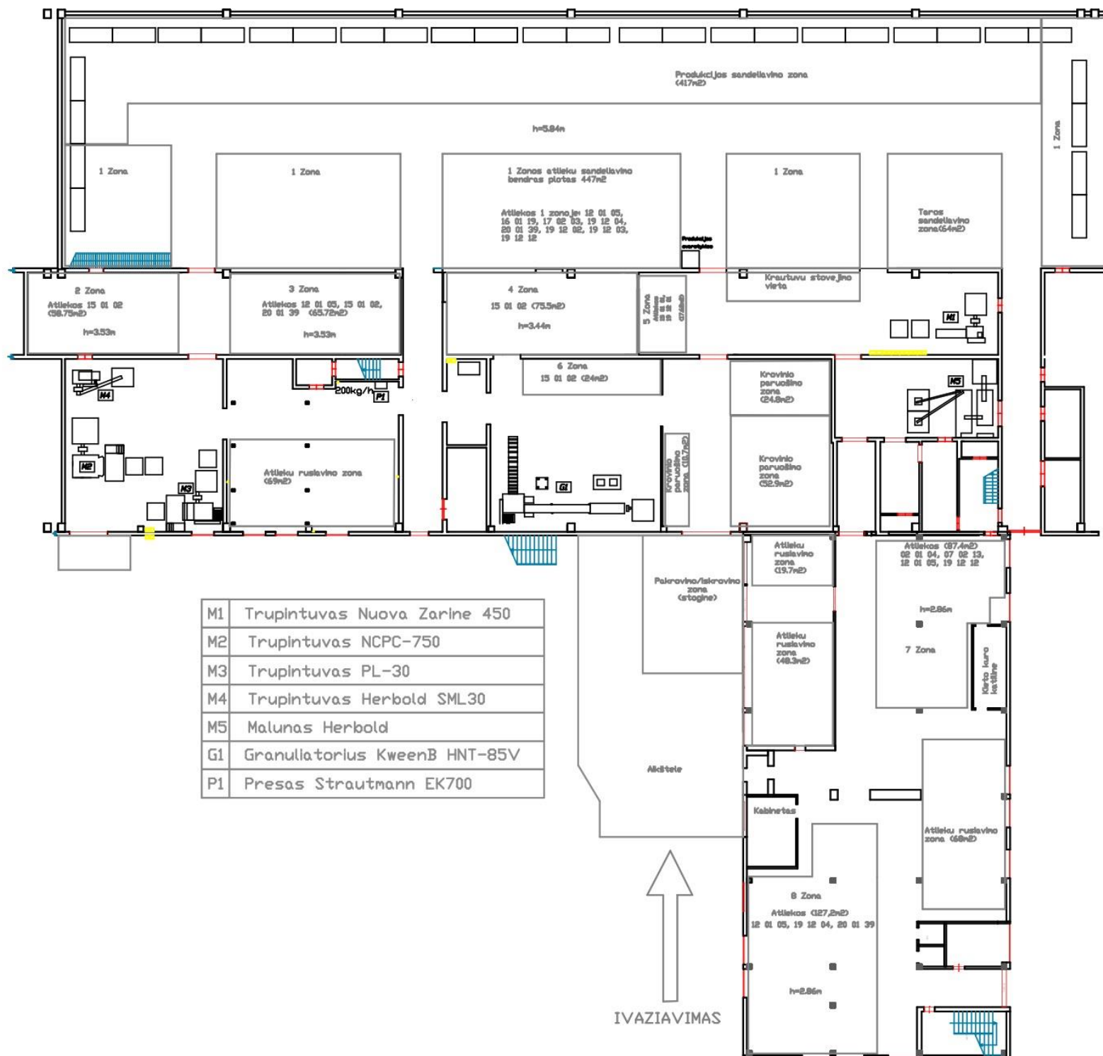
3 pav. UAB „Regeneracija“ Alytaus padalinio atliekų laikymo zonos ir įrenginių išdėstymo schema.
