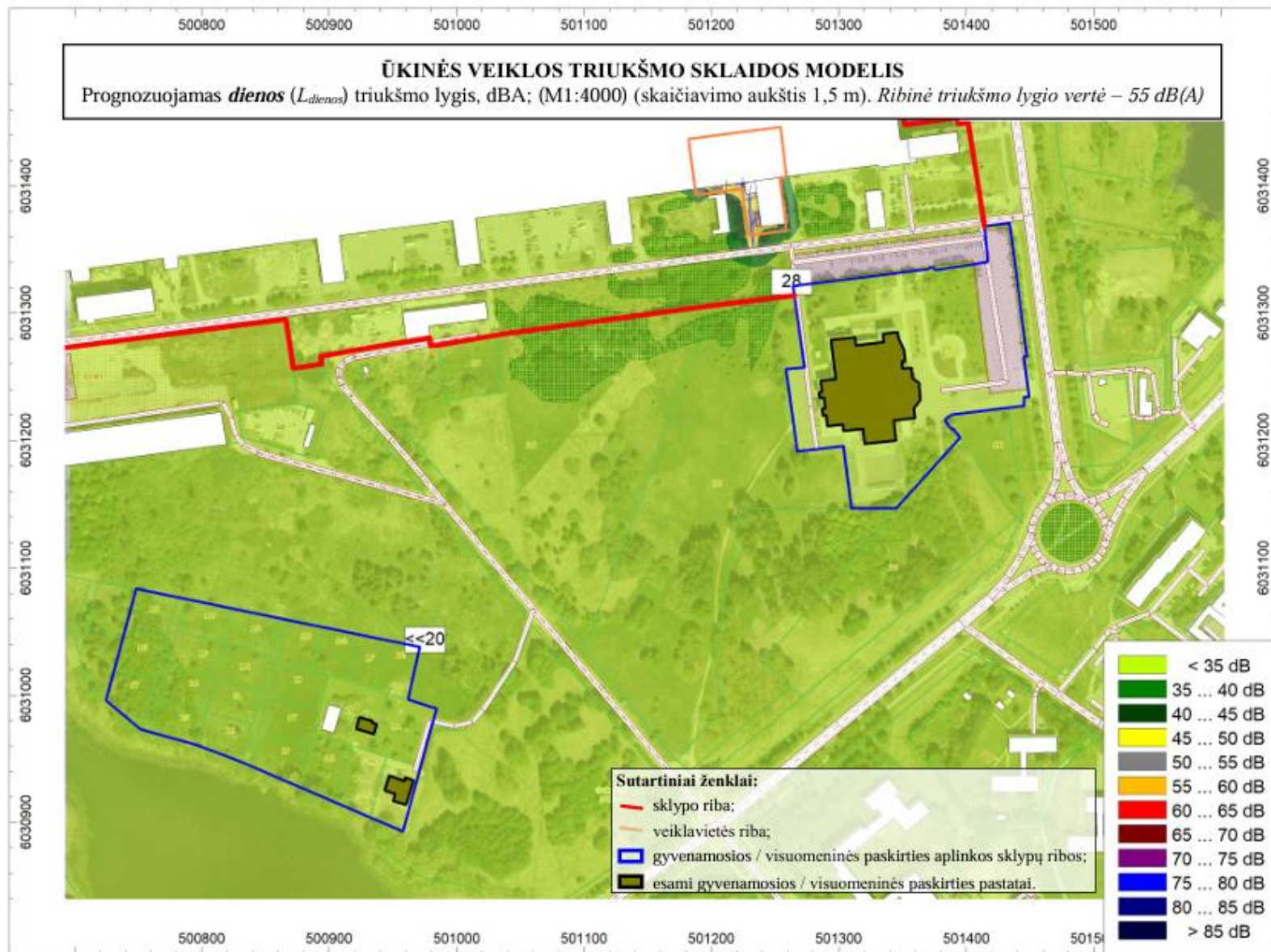
20 pav. Planuojamos ūkinės veiklos triukšmo sklaidos žemėlapis (dienos metu) (M1:4000)
