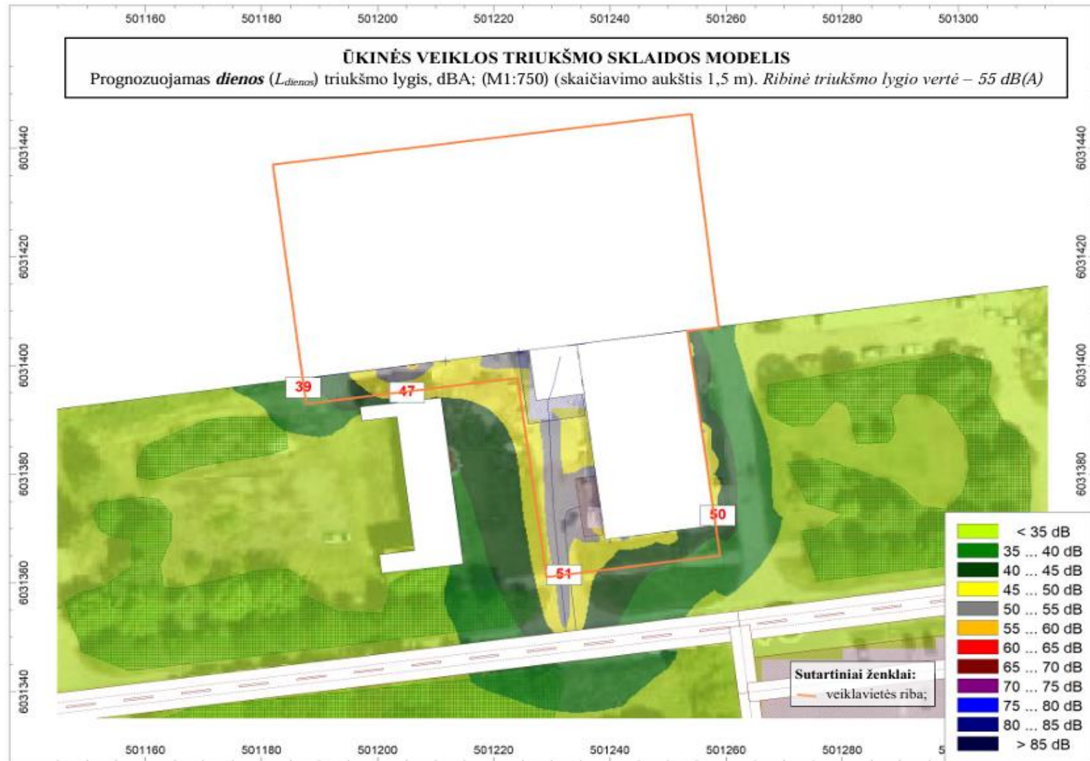
18 pav. Planuojamos ūkinės veiklos triukšmo sklaidos žemėlapis (dienos metu) (M1:750)
