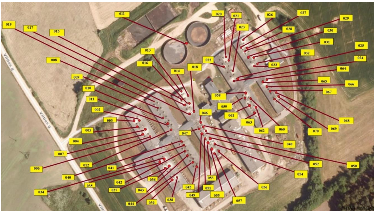
2 pav. UAB „Žiobiškio kompleksas“ teritorijoje ant pastatų stogų esančių stacionarių triukšmo šaltinių padėtis ir numeracija (003–071 – stoginiai ventiliatoriai, 611 skysto mėšlo maišyklė)
