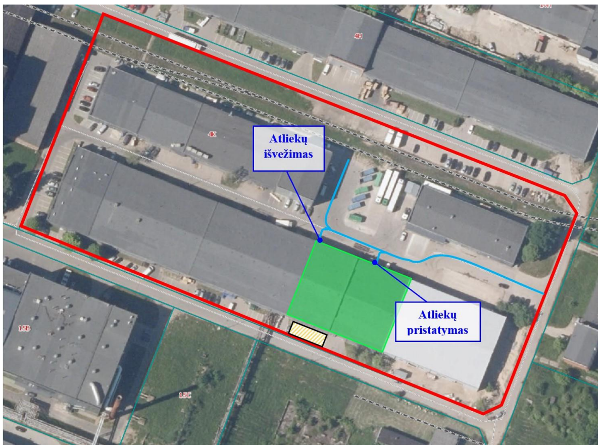
10 pav. PŪV zonavimo schema, stacionarių triukšmo šaltinių padėtis, sunkiasvorių transporto priemonių (TP) judėjimo tipinės trajektorijos
