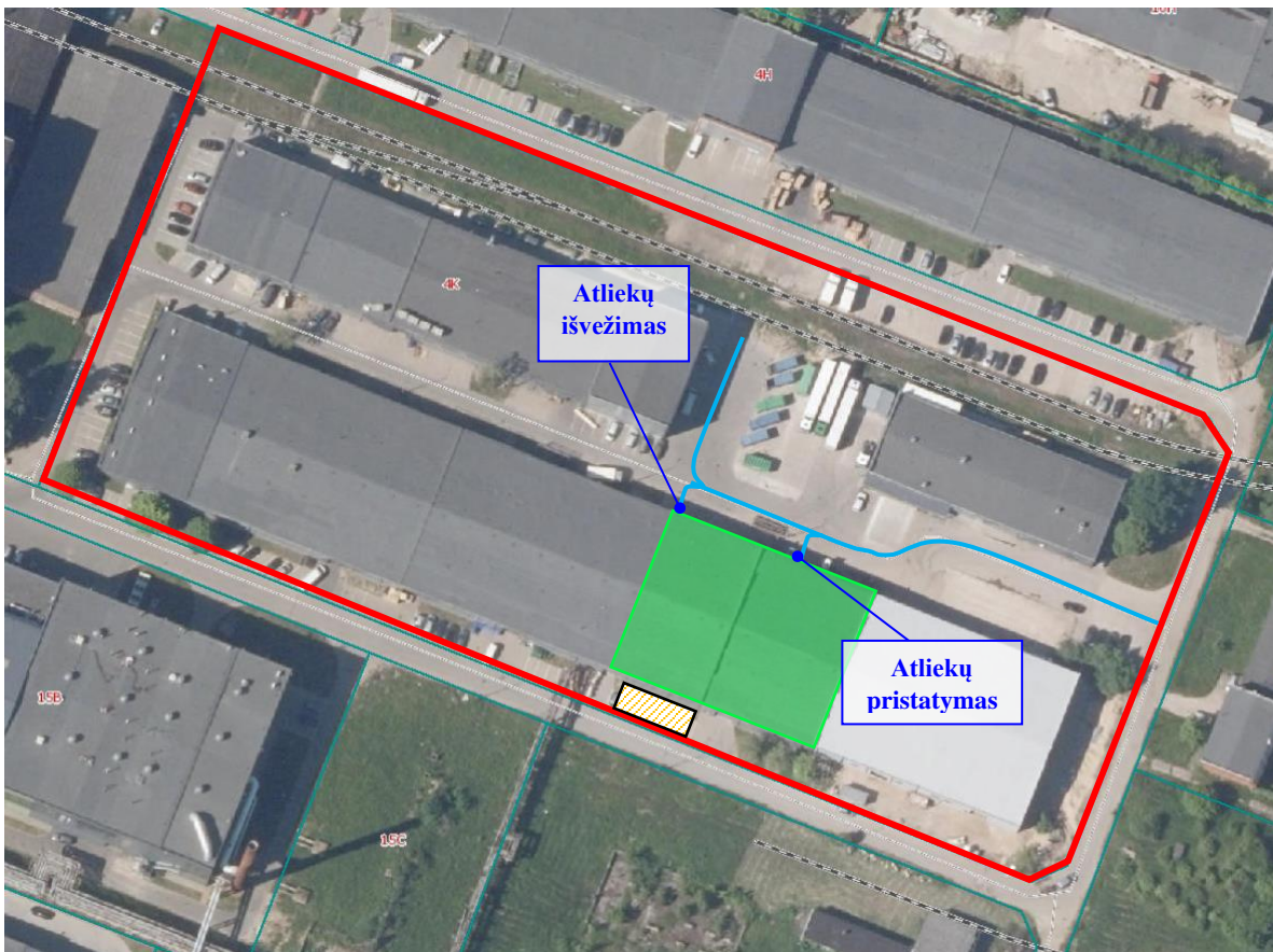
2 pav. PŪV zonavimo schema, stacionarių triukšmo šaltinių padėtis, sunkiasvorių transporto priemonių (TP) judėjimo tipinės trajektorijos
