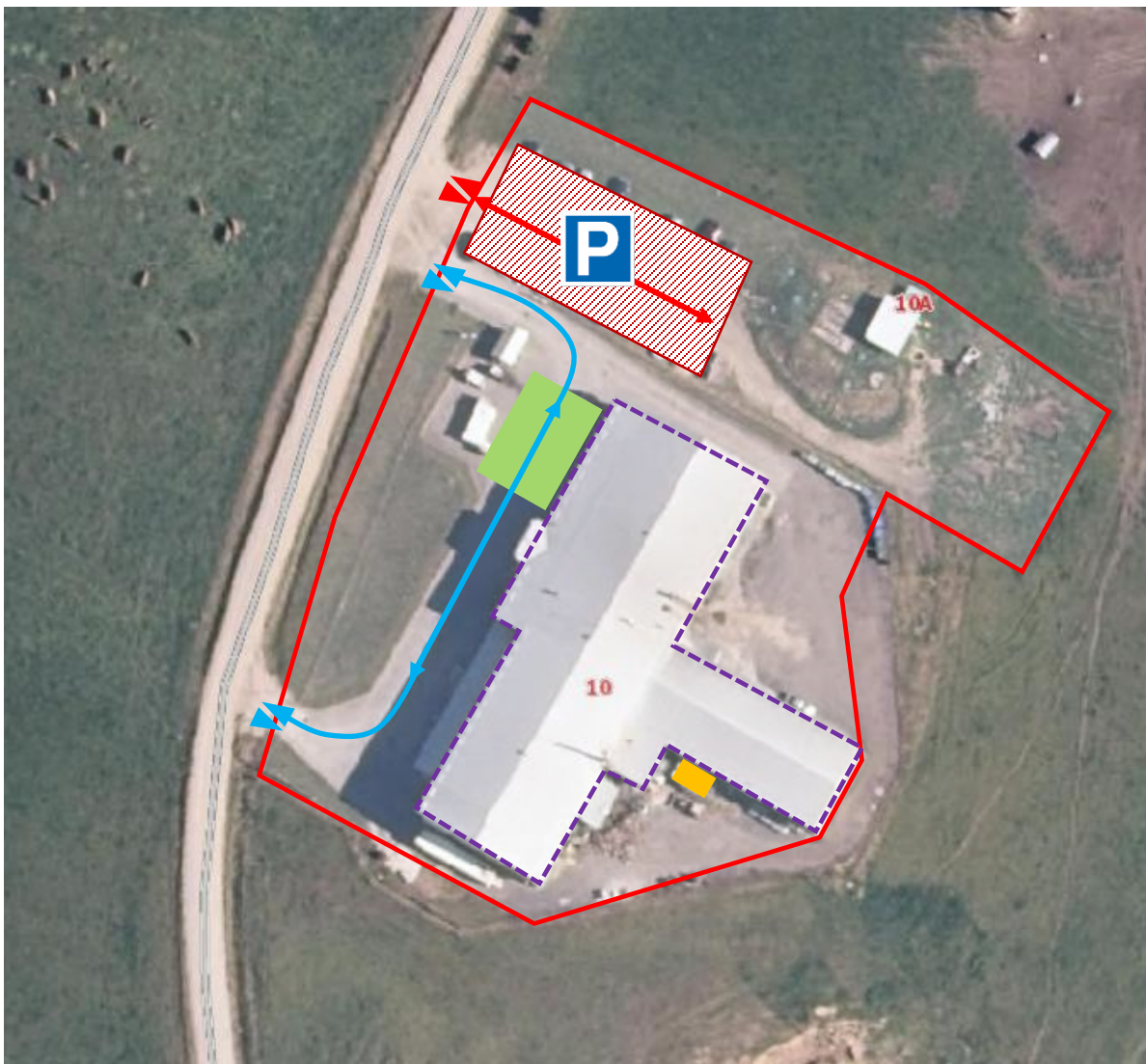
2 pav. ŽŪB Kontautėliai“ teritorijos ortofotografija, sklypų ribos (raudona linija), teritorijoje esantis pastatas, sunkiasvorių transporto priemonių judėjimo trajektorijos bei krovos zonos padėtis, taip pat lengvųjų automobilių stovėjimo aikštelės bei kondensatoriaus padėtis
